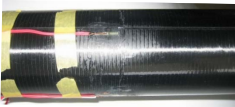
図10 単純支持梁の破断
