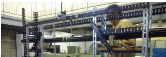
図8 単純支持梁試験状況
